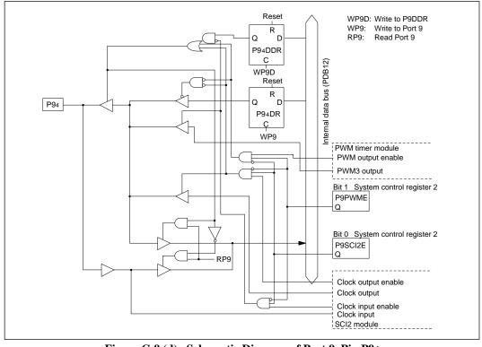
Figure C-9 (d) Schematic Diagram of Port 9, Pin P94
