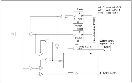
Figure C-1 (d) Schematic Diagram of Port 1, Pin P13
